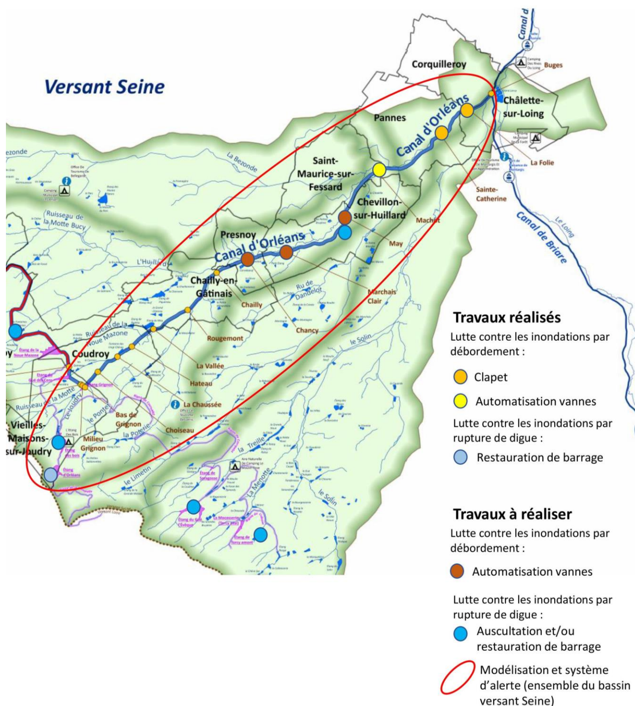
Figure 15 : Vue d'ensemble des travaux engagés et projetés sur le canal d'Orléans pour la lutte contre les crues (Source : Département du Loiret)
